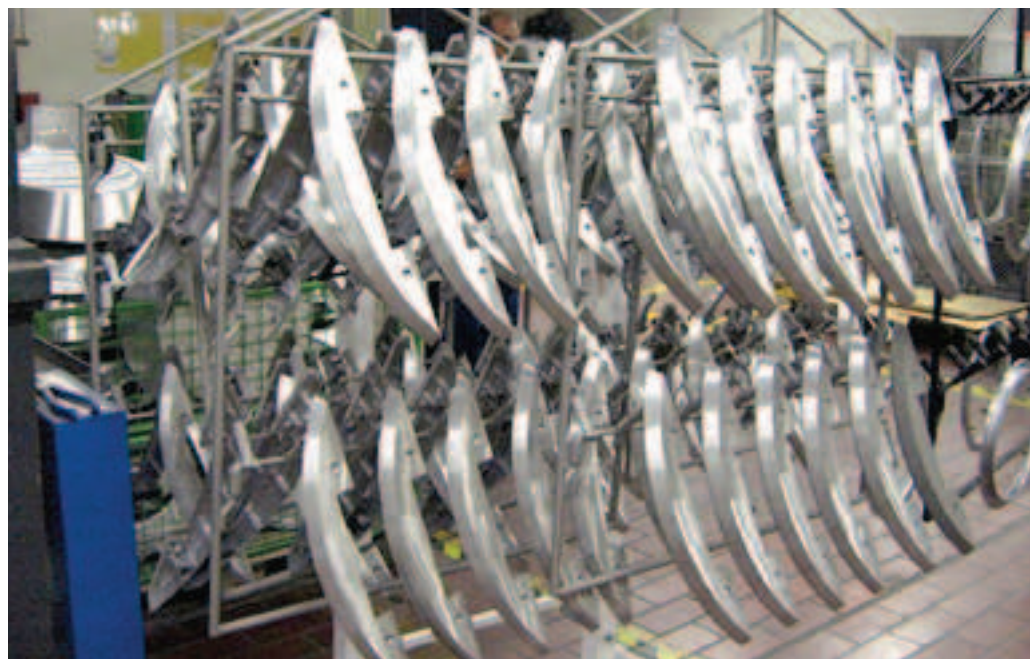
Der Leuchtenhersteller setzt in der Produktion jetzt neue, zum Teil für sein Werkstückespektrum speziell entwickelte Warenträger ein.
